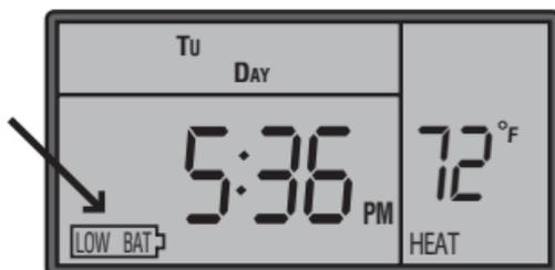
Pour remplacer les piles du thermostat, retirez le corps du thermostat de la plaque de base fixée au mur en pressant le loquet-pousier au bas et au centre de l'unité et faites pivoter le corps
